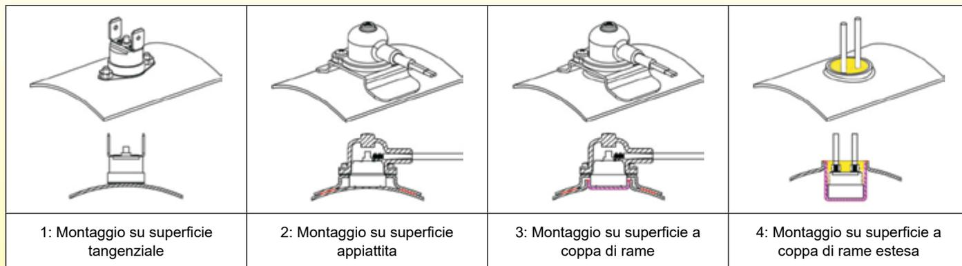
In condizioni di funzionamento normali, la temperatura del liquido che attraversa il riscaldatore è stabile perché è controllata da un termostato. I dispositivi di sicurezza come i limitatori di temperatura non devono intervenire. Per trovare le posizioni e i montaggi migliori dei limitatori di temperatura, è importante misurare i loro tempi di risposta in caso di surriscaldamento.
