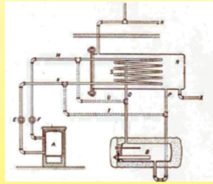
1927 Riscaldamento dell'acqua a doppia energia a carbone, Etelec, con scambiatore di calore tubolare all'interno di un serbatoio di accumulo. (Ultimheat Museum)
