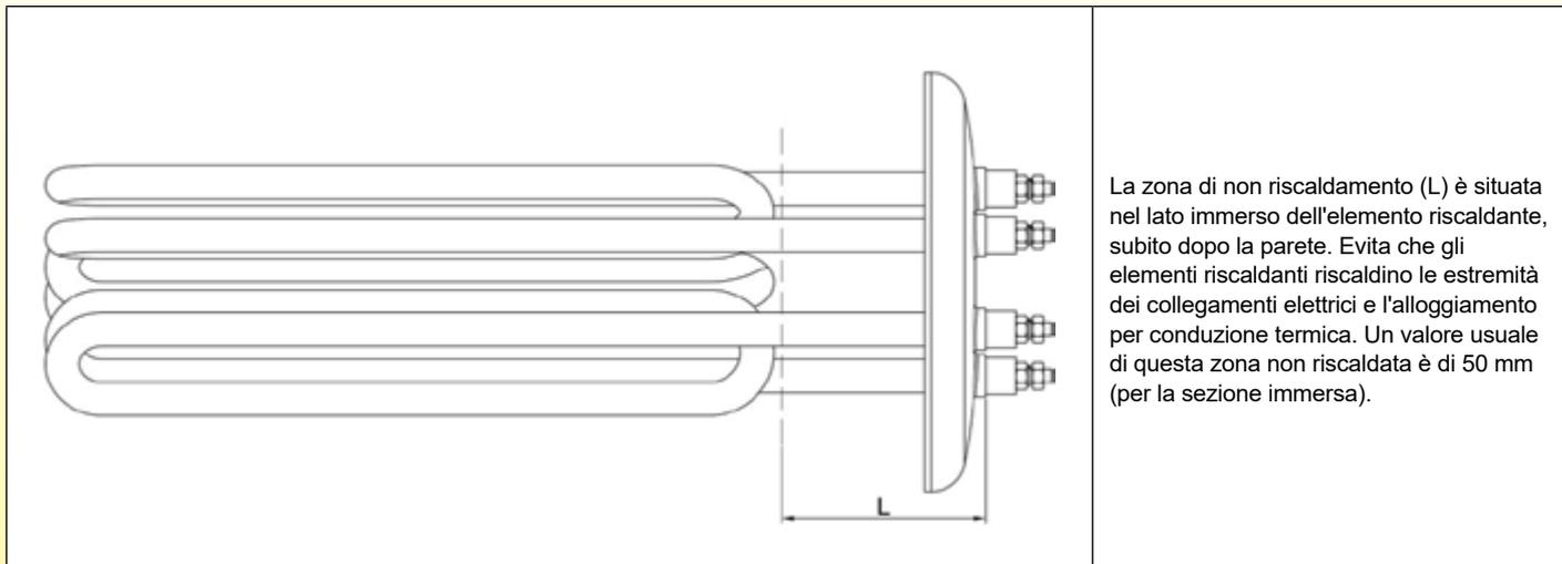
La zona di non riscaldamento (L) è situata nel lato immerso dell'elemento riscaldante, subito dopo la parete. Evita che gli elementi riscaldanti riscaldino le estremità dei collegamenti elettrici e l'alloggiamento per conduzione termica. Un valore usuale di questa zona non riscaldata è di 50 mm (per la sezione immersa).
