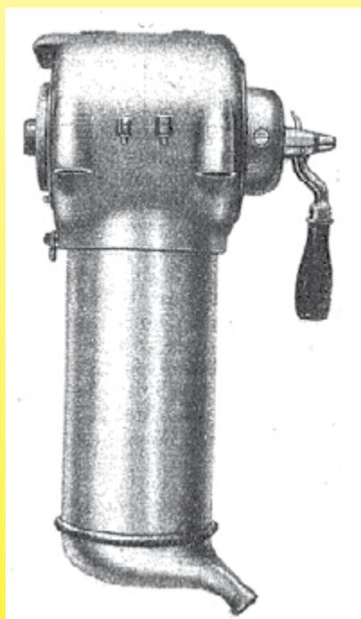
1922, la società Presto, Parigi, sviluppa uno scaldacqua istantaneo montato su rubinetto in cui l'acqua viene riscaldata dalla sua stessa conduttività, senza fili scaldanti. Questa soluzione tecnica, che aveva il difetto di essere molto sensibile alla qualità dell'acqua, è tuttora utilizzata per produrre vapore nelle macchine per togliere la carta da parati e in altre apparecchiature simili. (Documenti del Ultimheat Museum)
