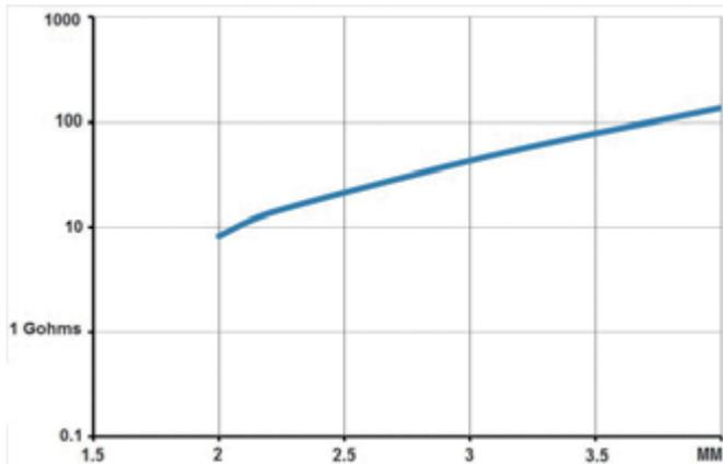
**Recupero dell'umidità (valore della resistenza di isolamento rispetto al tempo), riscaldatore tubolare non sigillato, lunghezza 100 mm, a 25°C e 90% R.H.**
