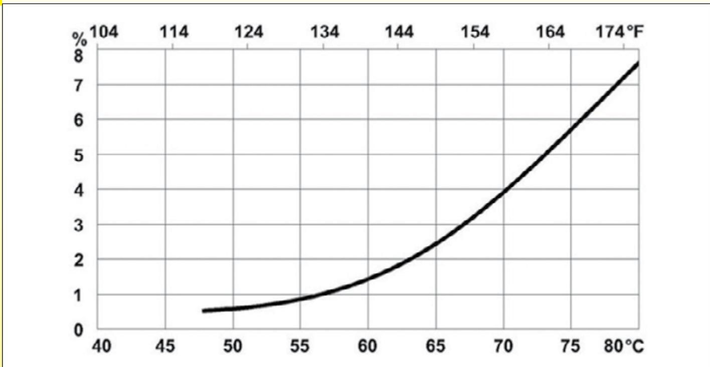
Questa figura mostra la percentuale stimata di sali minerali diluiti nell'acqua in circolazione che si depositano a contatto con le pareti calde del riscaldatore tubolare.
