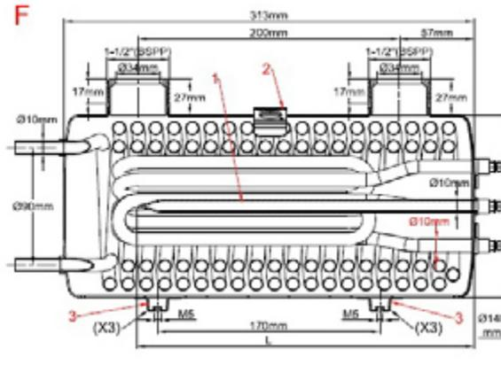
**Diametro del riscaldatore:** 10 mm
