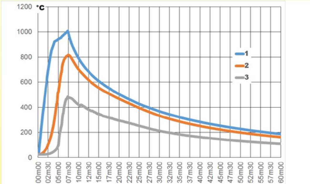
Test effettuati su un riscaldatore di liquido dia. 125 mm, con 3 riscaldatori tubolari da 1 kw ciascuno, carico superficiale di 5 W/cm<sup>2</sup>, con isolamento termico in schiuma NBR-PVC da 20 mm e rivestimento in alluminio.
