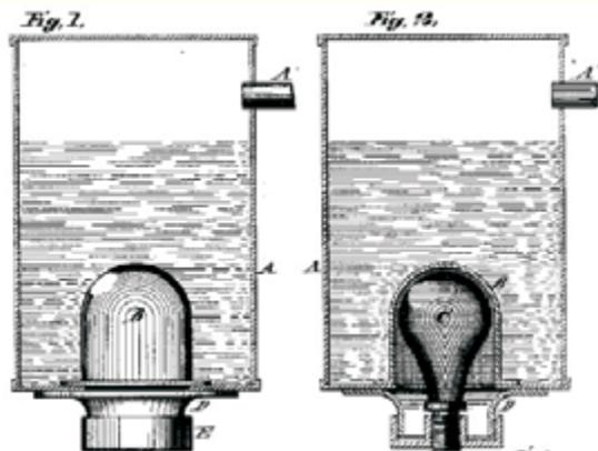
1889, Daniel Smith, di St Louis (Missouri, USA), deposita un brevetto per uno scaldacqua elettrico ad accumulo, il cui riscaldamento è fornito da un filo di platino all'interno di una lampada di vetro, sotto una cupola di protezione. (US patent 411737). Sebbene questo brevetto sia rimasto inutilizzato, può essere considerato il capostipite degli scaldacqua elettrici.
