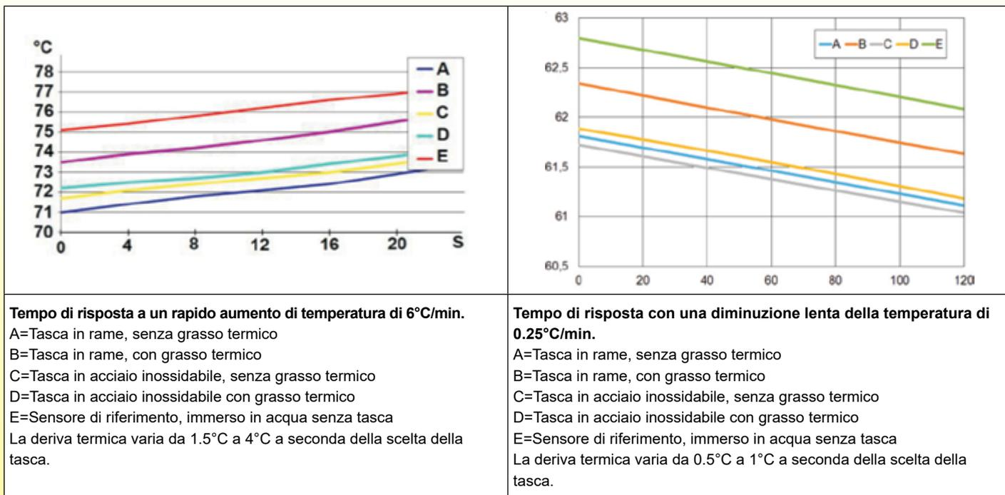
Lunghezza del pozzetto termico 100 mm, tubo con Diametro Interno di 6 mm dotato di un sensore di temperatura a resistenza Pt100 dia. 5 mm. Lo spessore della parete del tubo è di 1 mm in rame e 0.5 mm in acciaio inossidabile. Pozzetti termici affiancati nello stesso flusso d'acqua. Le soluzioni preferite in questo catalogo sono i pozzetti termici in acciaio inossidabile 304L o 316L, con una distanza di 0.5 mm dall'elemento di misurazione, e il grasso di contatto termico.
