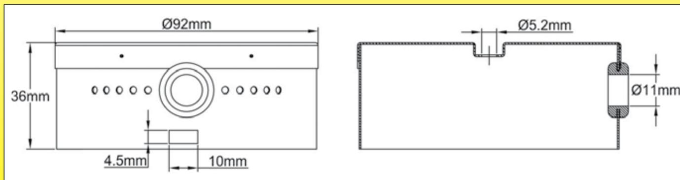
Per proteggere i terminali elettrici dagli urti, sulla flangia di uscita può essere montata a scelta una copertura in acciaio inossidabile. È fissata con una vite e un gancio nel terminale di terra. Non fornisce protezione contro le gocce d'acqua
