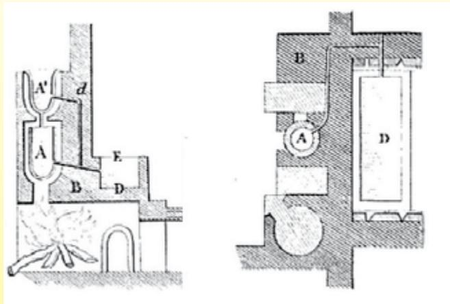
Sopra: Sezione di un bagno caldo di una villa romana a Pompei, che utilizza il principio del termosifone con due serbatoi A e A' che forniscono acqua alla vasca D tramite il tubo d. (Voyage pittoresque ou Description des royaumes de Naples et de Sicile, par l'abbé de Saint-Non (1781), vol. 2).
