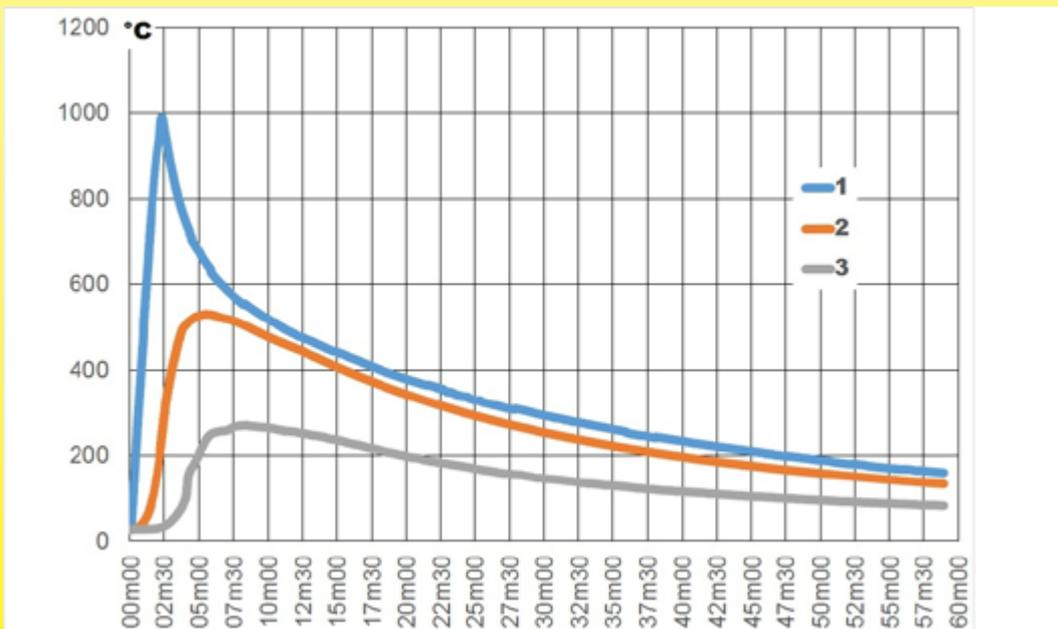
Test effettuati su un riscaldatore di liquido dia. 125 mm, con 3 riscaldatori tubolari da 2 kw ciascuno, carico superficiale di 10 W/cm<sup>2</sup>, con isolamento termico in schiuma NBR-PVC da 20 mm e mantello in alluminio.
