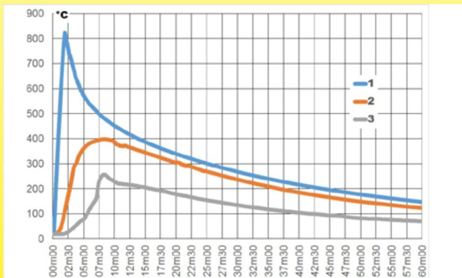
Test eseguiti su riscaldatore di liquido dia. 125 mm, con 3 riscaldatori tubolari da 2 kw ciascuno, carico superficiale 10W/cm², con isolamento termico in schiuma NBR-PVC da 20 mm e matello alluminato. Taglio termico di 122°C.
