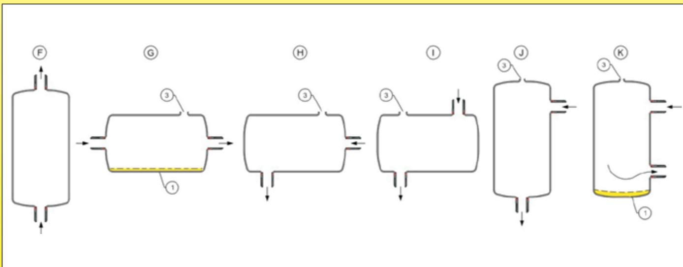
I disegni F, H, I, J mostrano progetti con angoli arrotondati. Le sacche d'aria sono evitate dalla posizione (F) o dalla presenza di uno sfiato d'aria (3). I depositi di fango si evitano se si rispetta la direzione del flusso. I disegni G e K mostrano un rischio di deposito di fango e possono richiedere un foro di drenaggio nella parte più bassa (1).
