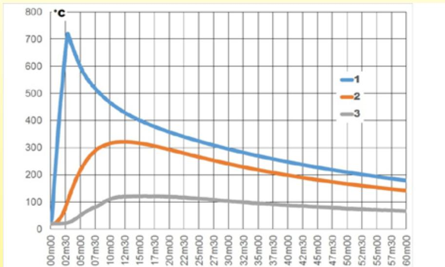
Test effettuati su un riscaldatore di liquido dia. 125 mm, con 3 riscaldatori tubolari da 2 kw ciascuno, carico superficiale di 5 W/cm², con isolamento termico in schiuma NBR-PVC da 20 mm e mantello in alluminio. Taglio termico di 122°C.
