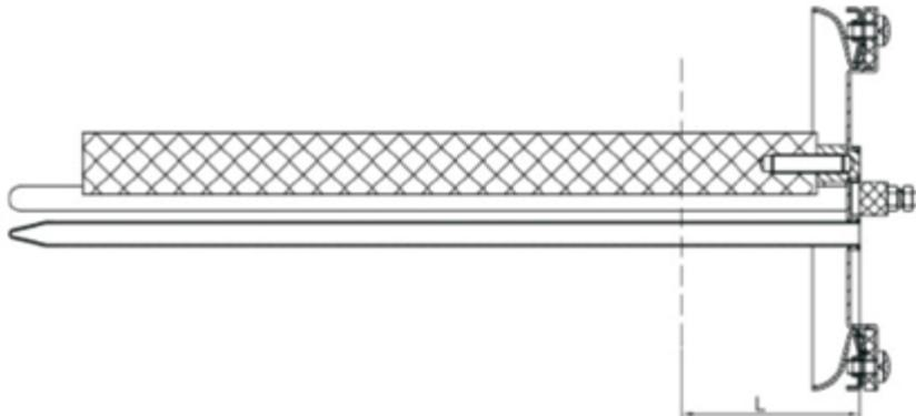
Il montaggio su una flangia stampata è una soluzione economica per i riscaldatori rimovibili, in quanto consente diametri elevati e l'installazione di anodi sacrificali in magnesio. Permette di rimuovere facilmente il riscaldatore dal serbatoio, per poterlo pulire, rimuovere fanghi e calcare e sostituire l'anodo.
