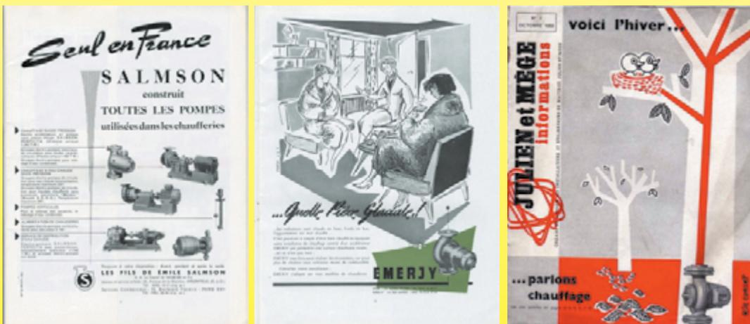
1955-57: Prendono il volo le pompe di circolazione elettriche per il riscaldamento centrale, prodotte da Emergy a Lione, Julien e Mège a Lione e Salmson a Parigi e Laval (utilizzando la Licenza Perfecta a rotore bagnato), che consentono ai progettisti di sistemi di riscaldamento ad acqua calda di superare i vincoli del termosifone. (Documenti del Ultimheat Museum).
