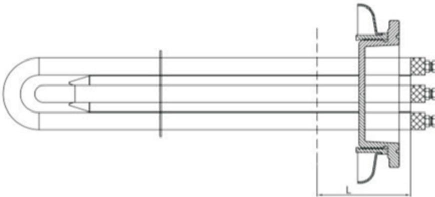
Nelle applicazioni professionali, saranno privilegiati i raccordi a vite (da 1" a 2" 1/2 o M77x2), ma le dimensioni limitate del raccordo e il suo diametro di passaggio presentano rapidamente dei limiti quando i riscaldatori devono essere piegati o ripiegati.
