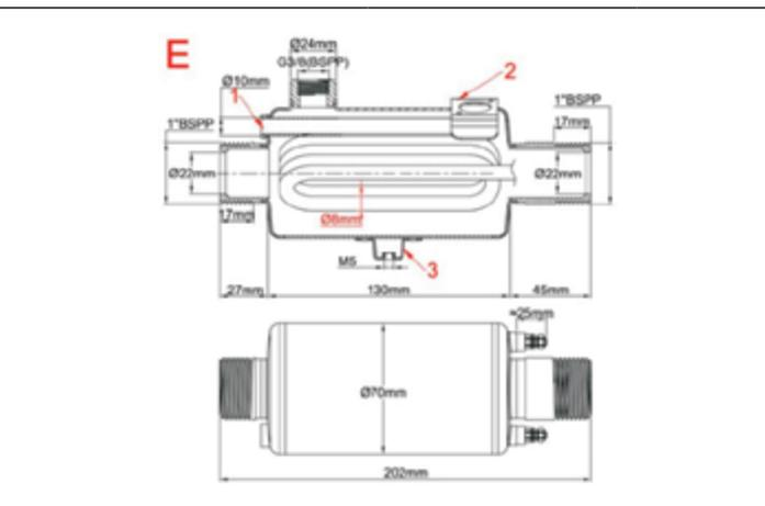
**Riscaldatore tubolare dia.:** 8 mm
