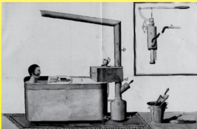
1820: Anche il riscaldamento delle vasche da bagno era uno dei centri di interesse dei ricercatori dell'epoca. M. Bizet, di Parigi, inventa una vasca riscaldata da termosifone (brevetto INPI), molto simile a quella utilizzata dai Romani. Per riscaldare la caldaia si utilizzava il carbone, sempre più diffuso a Parigi.
