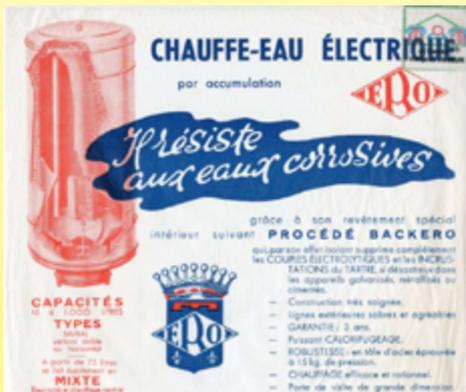
1946: la Company Ero (Sorgue, Francia) offre scaldacqua con serbatoi smaltati 200°C al posto di quelli zincati, cementati o metallizzati. Questo smalto è una resina termoindurente, tipo bachelite, la cui elasticità resiste all'espansione termica del serbatoio e che, isolando elettricamente le pareti, le protegge dalla corrosione galvanica. (Ultimheat Museum)
