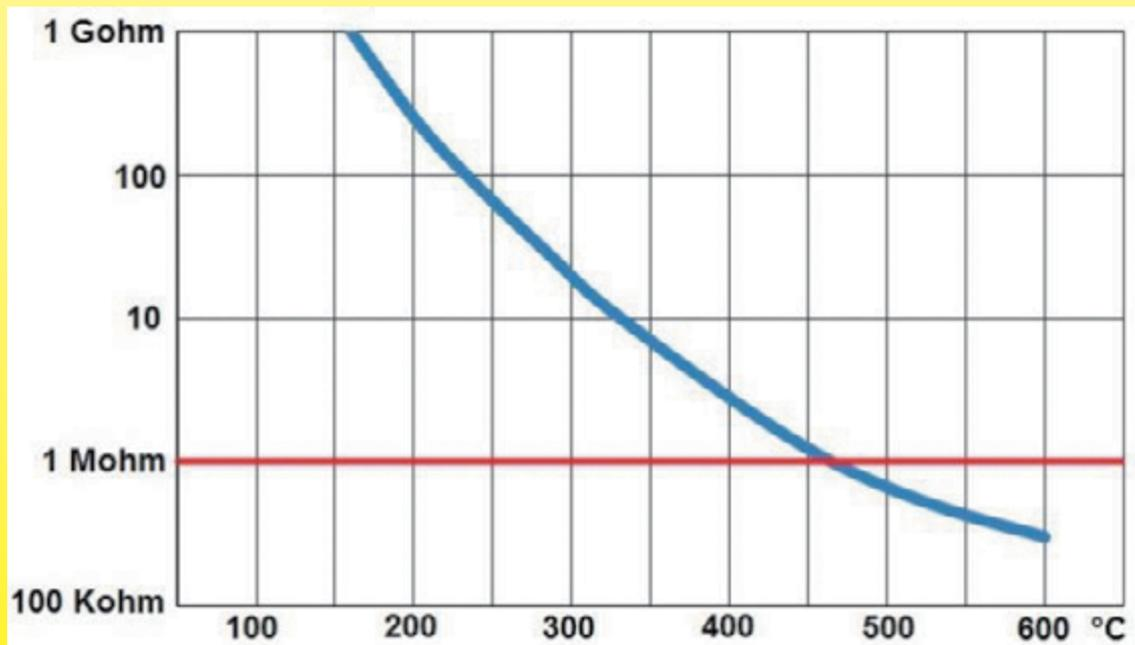
Valore di isolamento in funzione della temperatura di un riscaldatore tubolare con guaina di dia. 8 mm e lunghezza 1200 mm. (Misurato in un forno, su un riscaldatore tubolare con guaina precedentemente disidratato e senza guarnizioni terminali).
